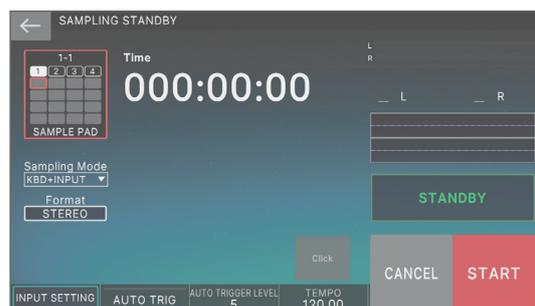
4. Das <SAMPLE PAD>-Feld zeigt die Bank und die Nummer des Sample-Pad an, für das die Aufnahme erfolgen wird.
